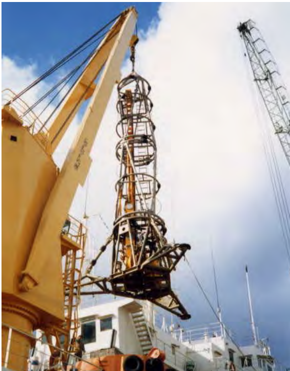
▲ワンビットラン式マリンドリル MDC-200/10-PSU (ソ連・サハリン東岸沖)
