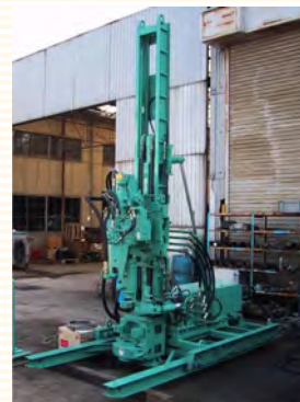
アース棒設置孔掘さく用アロードリル RPD-70KN
