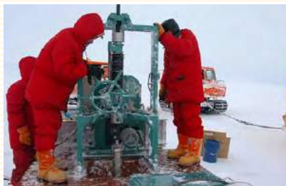
南極の海水に孔を開けるドリル SD-3D 国立極地研究所に納入
