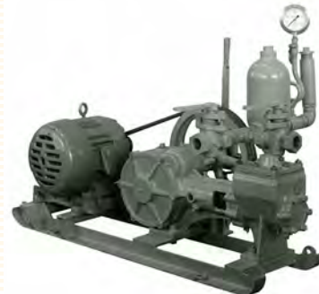
無段変量式のKP-6Sを新たに開発した。これは、KP-6ピストンポンプに吐出量を無段に変量させるカム機構を加えた最初のポンプで、PE、OEボーリングマシン用として使用した。
