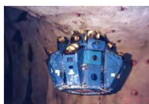
▲奥多々良木発電所 (兵庫県) 調圧水槽導坑掘さく 径 3,400mm BM-500A
