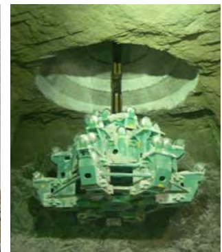
▲津久見鉱山（大分県）グローリーホール 立坑掘さく 径 6,000mm 深さ 143m BM-600A
