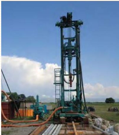
ODAによりタジキスタンに納入された リバース式大口径水井戸掘さく機 FSR-75A
