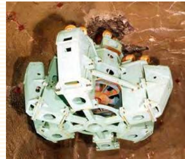
水資源開発公団 滝沢ダム(埼玉県)原石山立坑掘さく工事 BM-500A
