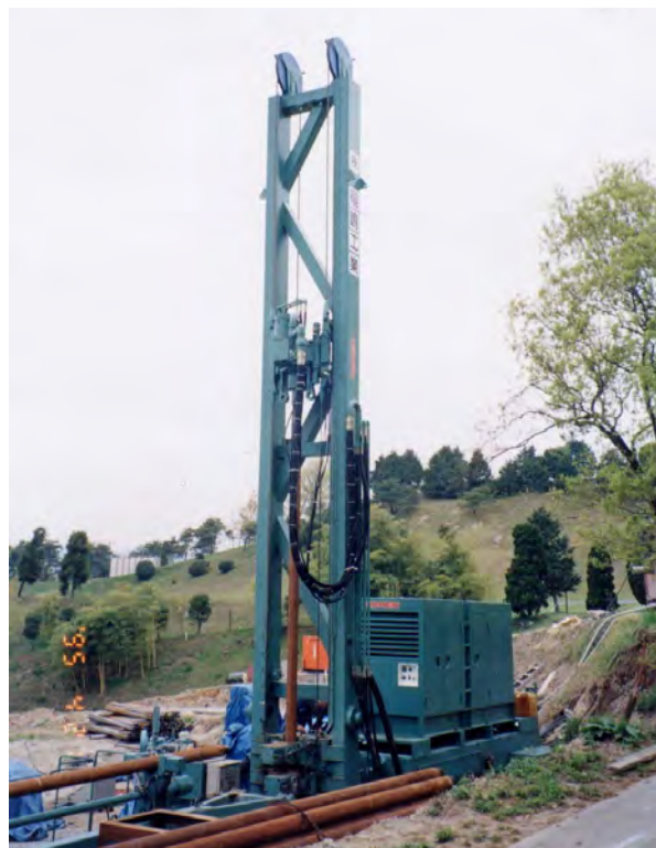
▲大分県日田市温泉掘さく スピードSPAドリルSSD-2000
