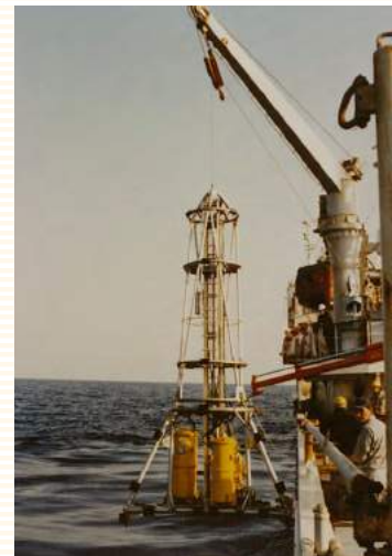
海底沈座式ボーリングマシン マリンドリル MD-500H 海洋調査船「白嶺丸」に搭載され、 相模湾においてテストボーリングを 実施した。
