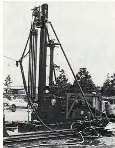
自動ロッド脱着装置付ボーリングマシン FX-40A 通産省重要技術開発補助金の交付を受けて研究開発した。FSを基本にして3mロッドの自動ネジ接続、離脱装置を付け、ボーリング作業の省力化に寄与するものとなった。
