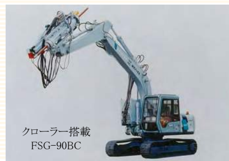
温泉ボーリング専用機 スピードSPAドリル SSD-2000
