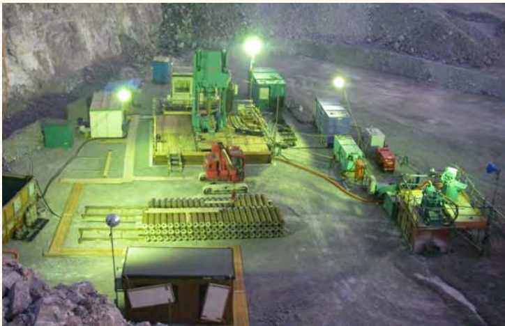
津久見鉱山(大分県)グローリーホール掘さく BM-600A(径6m×143m)
