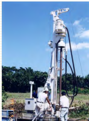
二重管水井戸掘さく機 愛称「せせらぎ号」 FGW-15E-B
