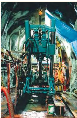
TBM先進ボーリング用アロードリル RPD-100SL-K2-OY
