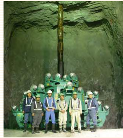
津久見鉱山(大分県)グローリーホール掘さく BM-600A(径6m×143m)
