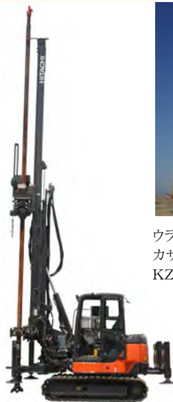
日立建機(株)と共同開発された住宅 地盤改良機 FSPG-50BC
