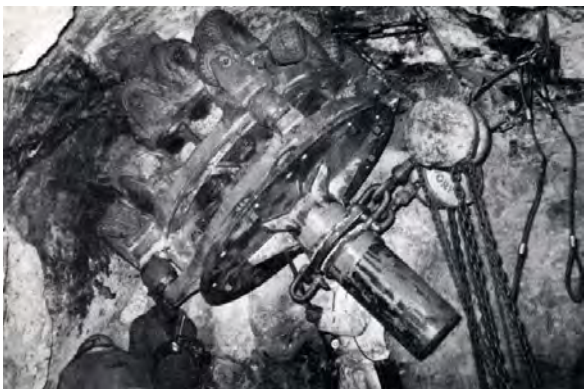
▲ザンビア(アフリカ)ルアンシャ鉱山 斜坑掘さく径1,830mm×下向き50°
