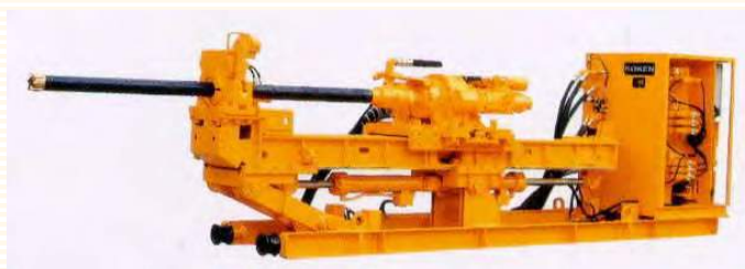
TBM先進ボーリング用アロードリル RPD-100SL-K2-OY
