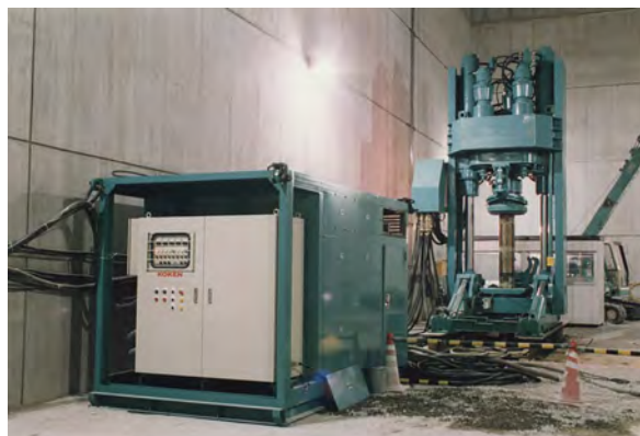
▲奥多々良木発電所 (兵庫県) 調圧水槽導坑掘さく 径 3,400mm BM-500A
