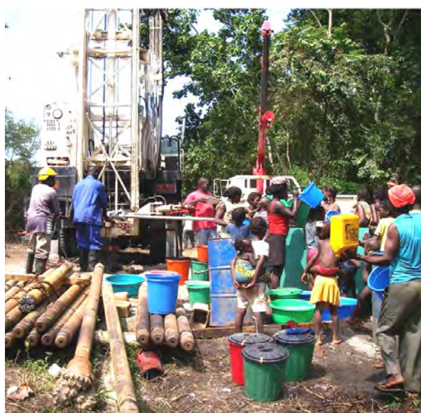
▲アンゴラ トラックマウント水井戸掘さく機 FSW-7T
