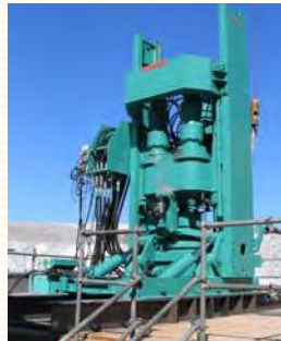
新開発された大口径岩盤掘さく 機 ビッグマンBM-600A
