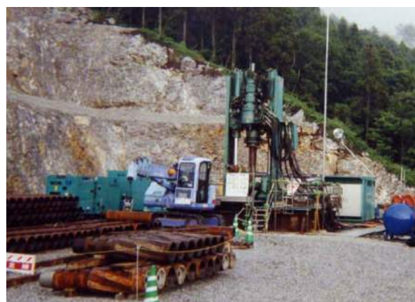
▲津久見鉱山（大分県） 立坑掘さく 径 4,750mm 深さ 417m BM-500A
