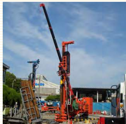
地中熱井戸掘さく用 バイブヘッド搭載 ロングストローク機 RPD-150C(3)-VNT-3M
