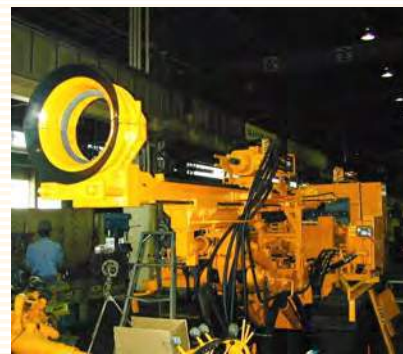
転炉出鋼口のスリーブ交換用掘さく機 アロードリル RPD-100C-NKK
